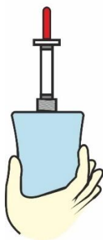
Abb. 5.8-3: Montage der Schlauchdosierpumpe auf INFRATRONIC SOLUTIONS Soft Systemflaschen
