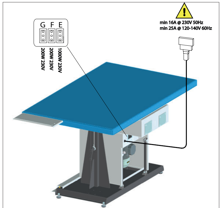
Abbildung 3.13 – Elektrischer Anschluss
